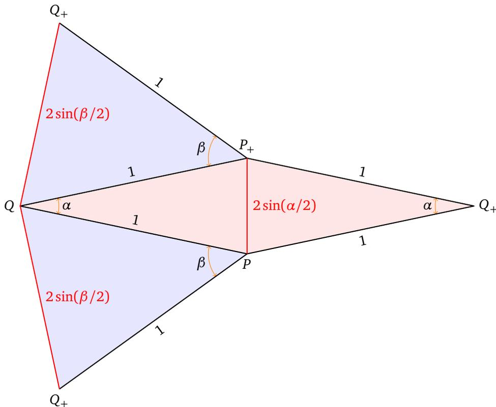
Die beiden Diagonalen des Vierecks ( $\overline{PP_+}$  und  $\overline{QQ_+}$ ) haben die im Bild angezeigten Längen. Die vier Innenwinkel (Diederwinkel  $\Phi$ ) an den Kanten zweier verschiedenfarbiger Dreiecke sind aus Symmetriegründen alle gleich und erfüllen die Identität
