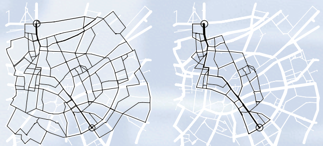
Fluß mit minimalen Gesamtkosten zwischen zwei Knoten (markiert) ohne Beschränkung der geographischen Länge (links) und mit Beschränkung (rechts).
