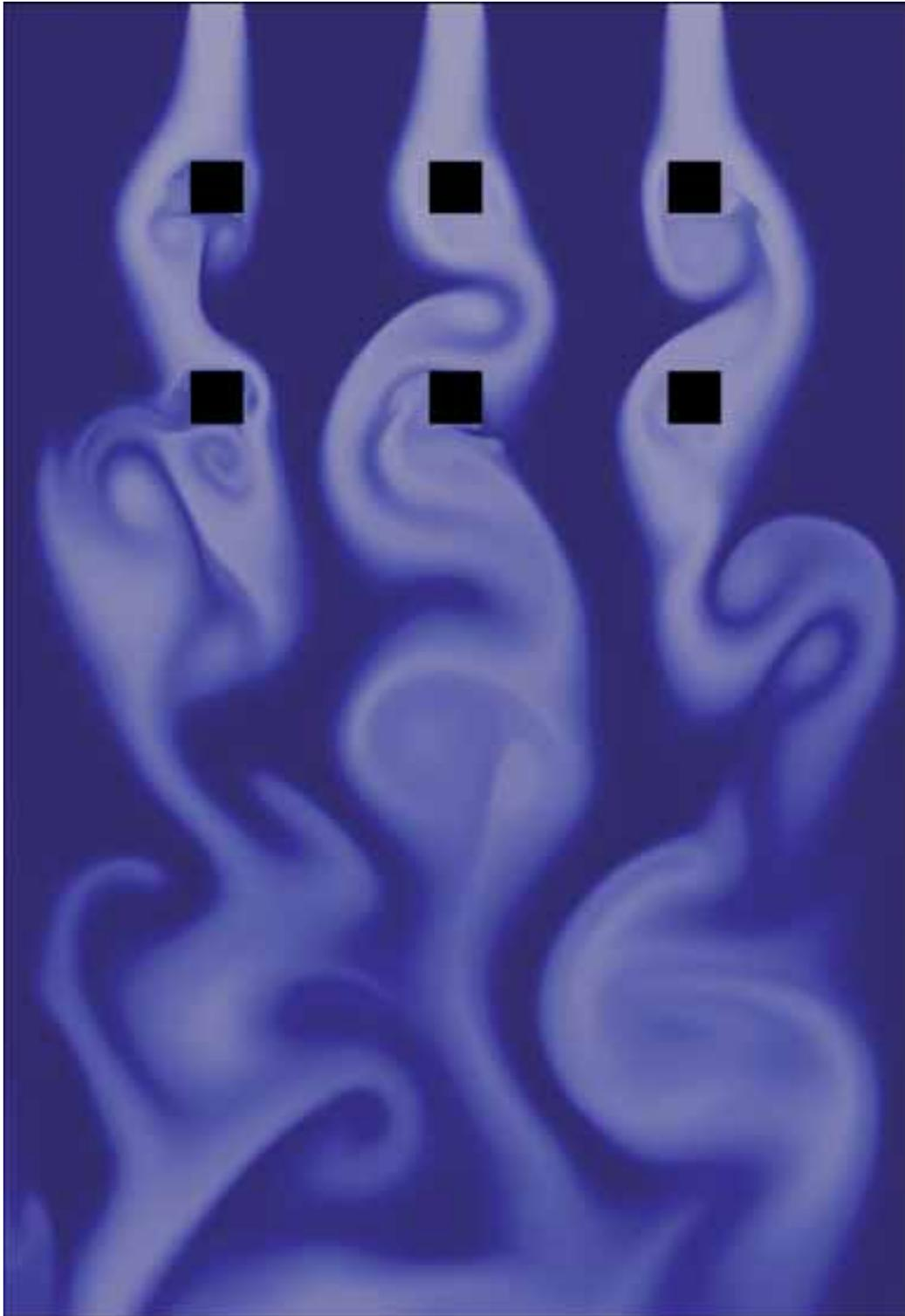
Um die Strömung hinter sechs Pfeilern einer kurzen Brücke über einen Fluß sichtbar zu machen, wurde das Wasser an drei Stellen vor den Pfeilern eingefärbt. Die Simulation mit mehr als 4.65 Millionen Unbekannten im Ort wurde von Jens F. Acker am Lehrstuhl III der TU Dortmund mit Hilfe des Simulationspaketes FEATFLOW durchgeführt. Animationen des Flusses gibt es unter <http://featflow.de/en/examples.html> zu sehen.
