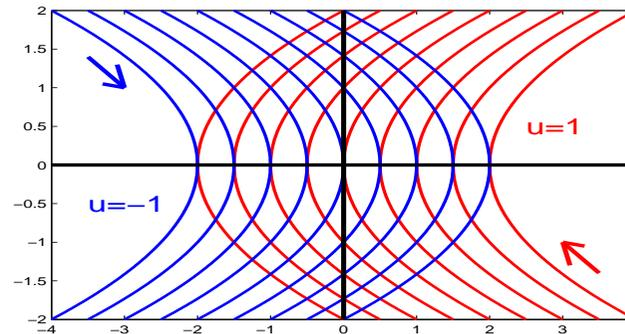
Die Parabelhälften, die bei 0 einlaufen, sind im unteren Bild schwarz eingezeichnet. Sie bilden die sogenannte Schaltkurve. Schaltregel um optimal nach Null zu steuern:
