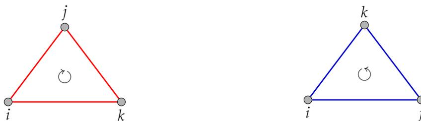
Abbildung 1: Links ein im Uhrzeigersinn orientiertes Dreieck, rechts eines im Gegenuhrzeigersinn.
